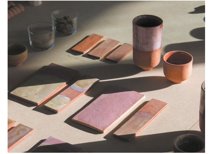
Carreaux et objets réalisés en terres d'excavation du Grand Paris © Lucie Ponard
